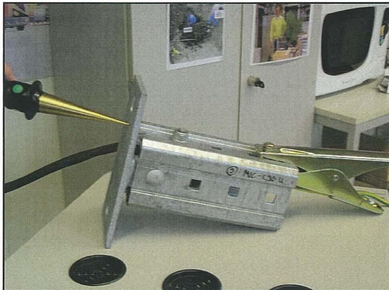
**Bild 4:** Messaufbau vor der Korrosionsprüfung
